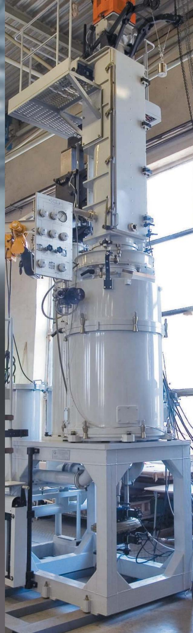
**Установки для выращивания монокристаллов** — важнейшее оборудование в электронной промышленности. Вся современная элементная база строится на подложках, вырезанных из монокристаллического буллы — искусственно выращенного монокристалла, производимого одним из доступных методов: горизонтально направленной кристаллизации, Киропулоса, Чохральского, и пр.
