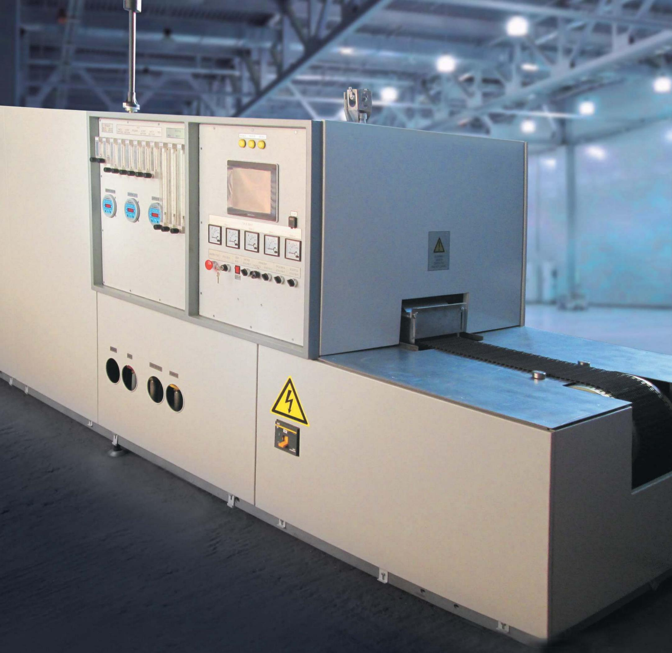
**Конвейерная электропечь** — электропечь сопротивления проходного типа с непрерывно или периодически движущимся конвейером.
