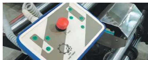
Выносной пульт и газовая горелка
