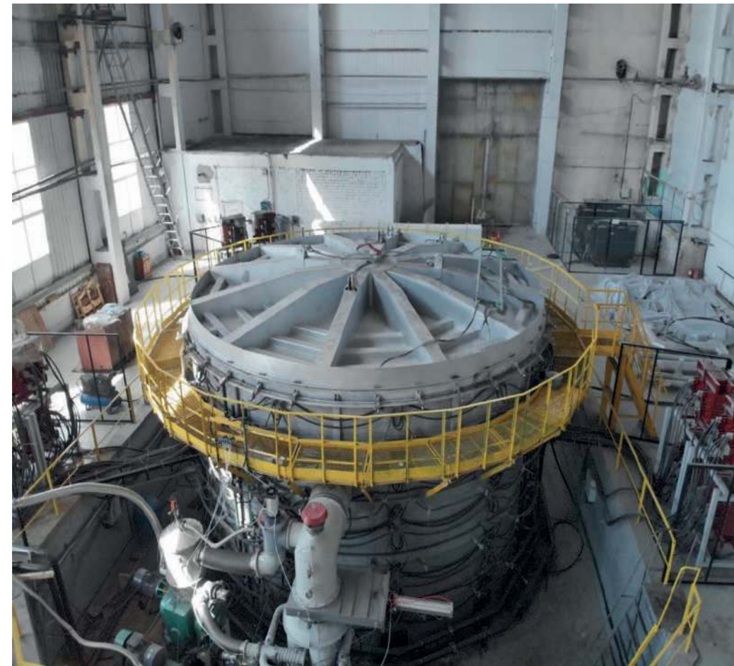
Крупногабаритная вакуумная шахтная печь сопротивления – модель разработана в ООО «НПО «ГКМП».
