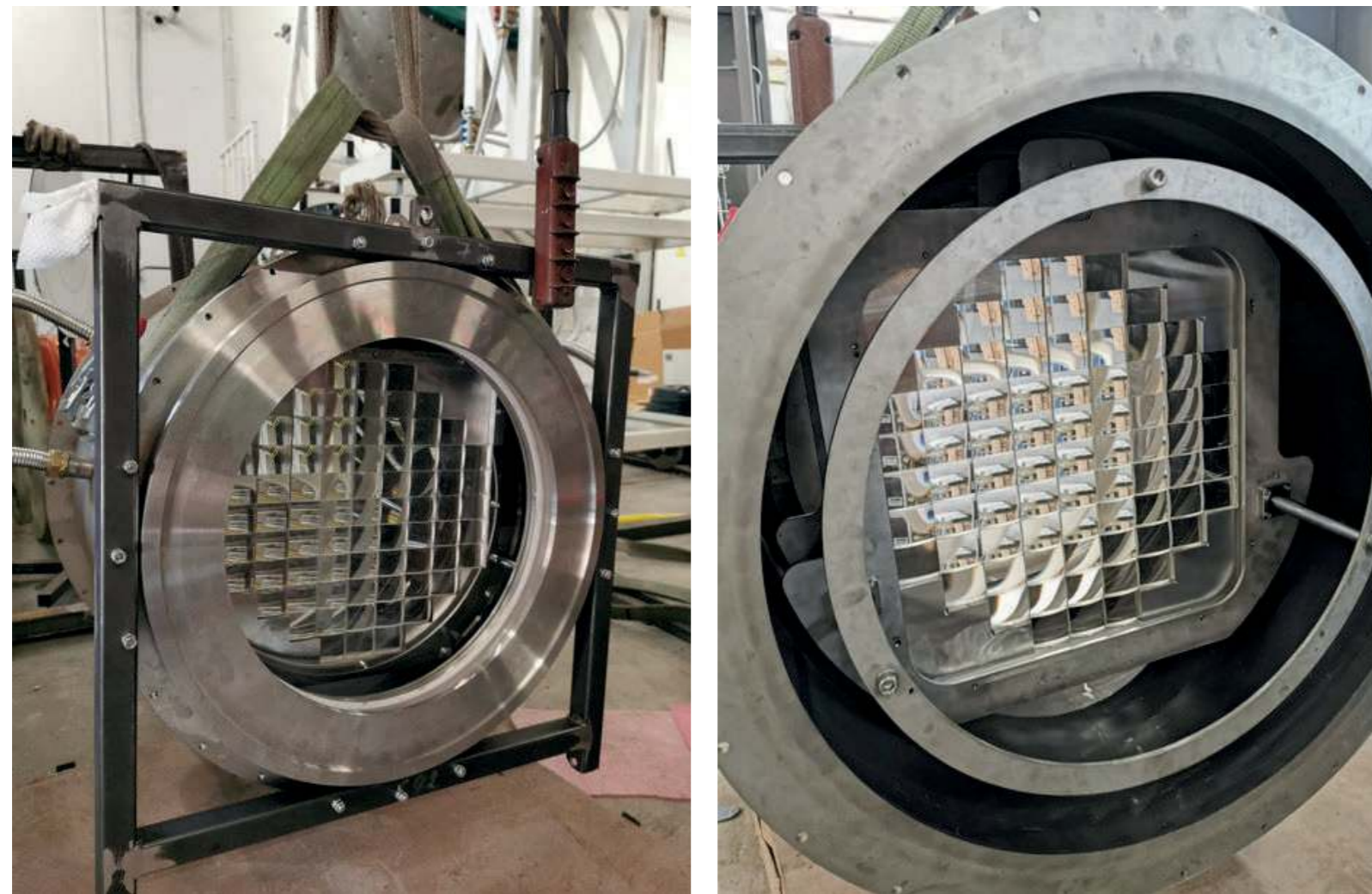
Перестраиваемый по углу засветки имитатор Солнца для испытаний оптико-электронных систем космического базирования
