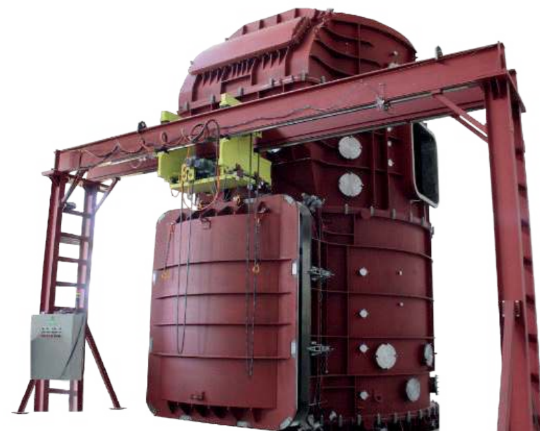
Стенд термовакuumных испытаний СТВИ-2
