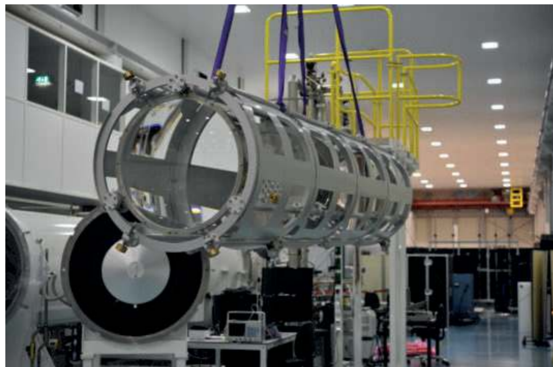
Имитатор Солнца VTC 1.5 позволяет проводить испытания миссий, простирающих свои пределы от околосолнечных орбит до орбиты Марса.
