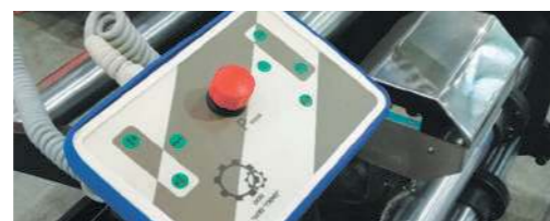
Выносной пульт и газовая горелка
